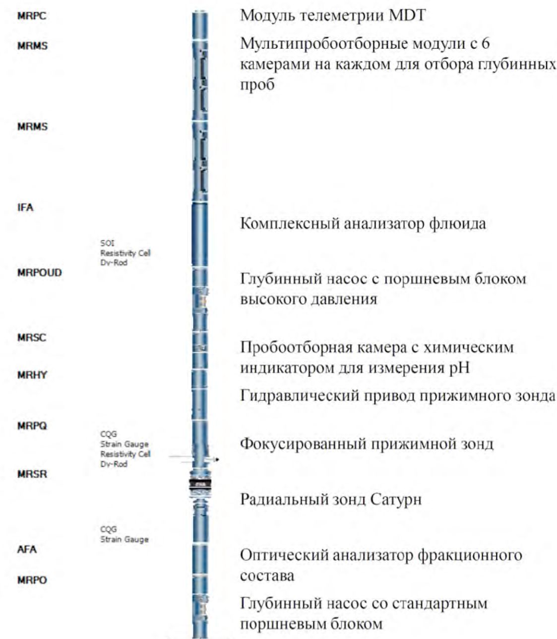
Рис. 6.5 Компоновка приборов MDT
