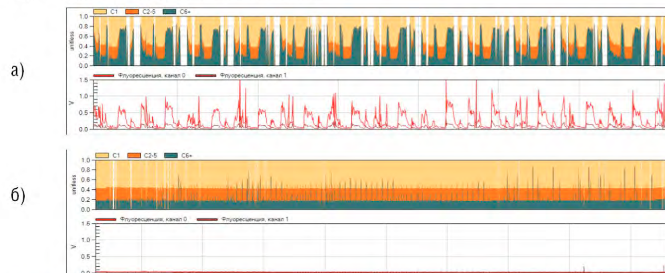
Рис. 4.1. Диаграмма ОПК при опробовании газонасыщенного интервала
