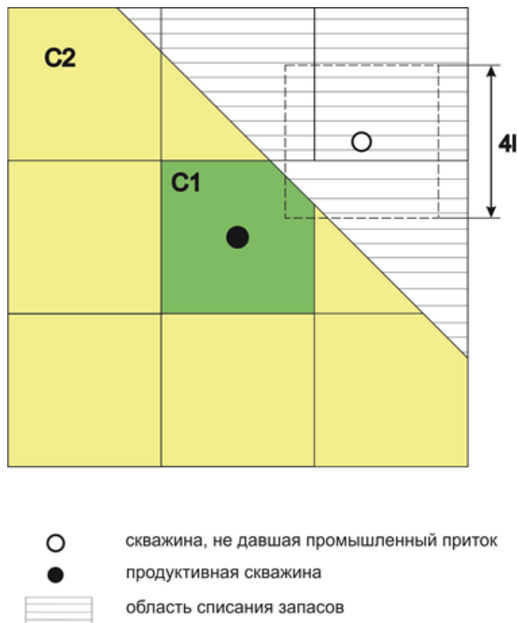
Рис. 5 Схема списания запасов при отрицательном результате испытания вертикальной скважины, пробуренной в категории C_2
