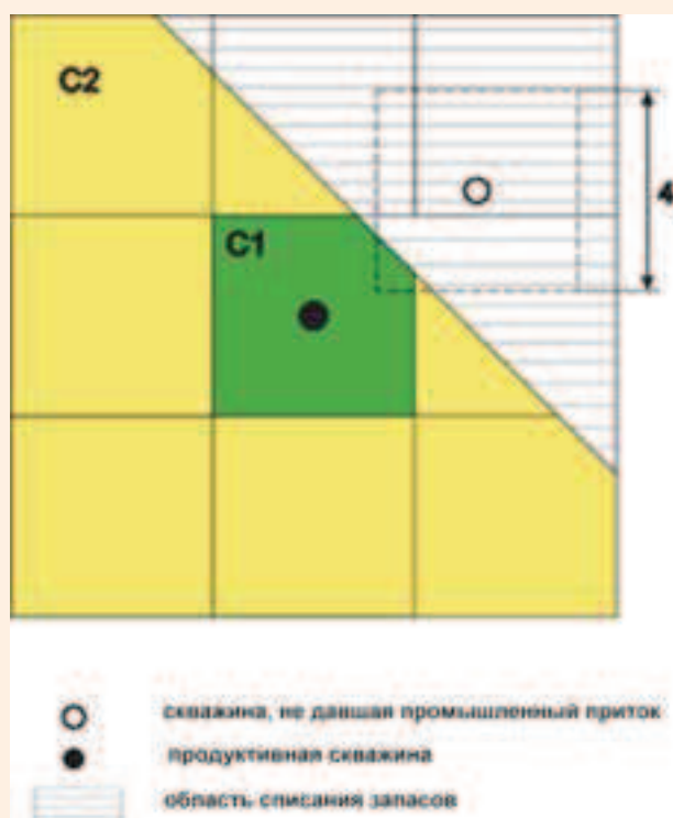
Рис. 3.5. Схема списания запасов при отрицательном результате испытания вертикальной скважины, пробуренной в категории C_2
